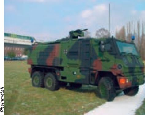
elevaciju od -9 do +60 stupnjeva, a pokrivaju svih 360 stupnjeva. Podstavni stabilizatori, laserski daljinomjer, termovizor, IFF uređaj i slično postavljaju se prema zahtjevu kupca. Prvih 300 kupola trebalo bi se njemačkoj vojsci dostaviti tijekom 2008. godine.
