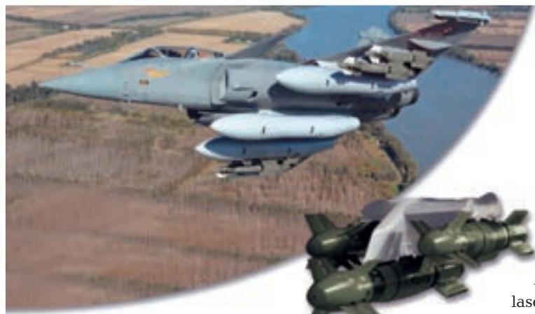
serski navođeni projektil AS-30L, a rabit će ga i kao dopunu Scalp EG oružnom sustavu. U svojoj temeljnoj konfiguraciji uz GSP/INS navigacijski kit (omogućava preciznost do 10 m) AASM je dobio i pasivni infracrveni sustav za navođenje, što omogućava preciznost usporedivu s laserski navođenim sustavima. U tijeku
