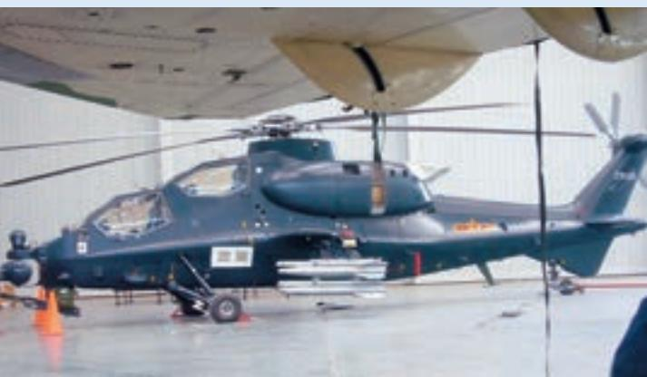
**ODNEDAVNO** se u svjetskom tisku mogu vidjeti nove slike prototipa novog kineskog borbenog helikoptera Z-10. Ono što je zasad poznato, riječ je o trećem dosad izrađenom prototipu, koji nosi oznaku Z-10-03A. Prvi put su to iznimno čisti snimci, koji tako mogu potvrditi brojne dosadašnje pretpostavke i postaviti nova pitanja. Temeljno je zamišljen kao borbeni helikopter za blisku zračnu potporu postrojbama KoV-a, ali helikopter Z-10-03A ima određene mogućnosti za zračnu borbu.
