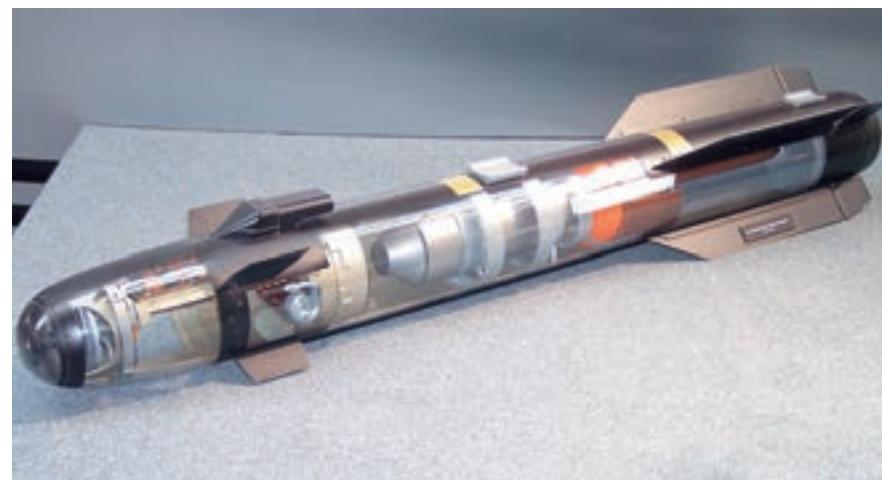
glavom) namijenjena za napade na plovila, planinske pećine, laka oklopna vozila i razne zemaljske objekte, a treća je inačica AGM-114N (s pojačanom fugašno-rasprskavajućom bojom glavom) namijenjena za napade na kopnene postrojbe i razne otvorene građevine.
