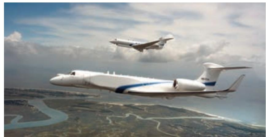
nom zrakoplovstvu uveden je u veljači 2007. Drugi Gulfstream G550 Nachshon-Eitam isporučen je u veljači ove godine. Napredni paket opreme za elektronsko djelovanje i izviđanje iz zraka razvila je tvrtka ELTA Systems Ltd, čiju su ugradnju, uz brojne strukturalne preinake, obavile tvrtke Israel Aerospace Industries i Gulfstream Aerospace. Pogonsku skupinu na Gulfstreamu G550 čine dva motora Rolls-Royce
