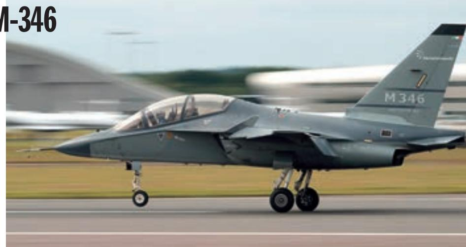
2004 godine. Ukupna težina novopredstavljenog M-346 manja je za 700 kg od dosadašnjih prototipova, a to se postiglo većom primjenom kompozitnih materijala u proizvodnji aviona, brojnim strukturalnim promjenama krila i trupa, te ugradnjom novoga glavnog stajnog trapa. Važan pomak ostvaren je i u smjeru lakšeg opsluživanja i održavanja aviona, odnosno lakše zamjene pojedinih sustava na njemu. Tvrte Alenia SIA i SELEX Communications velik pomak naprijed ostvarile
