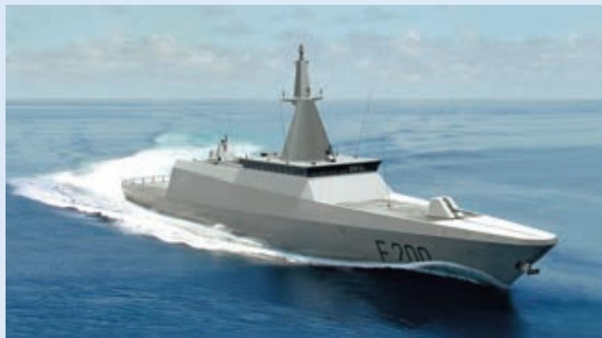
nu brzinu veću od 30 čv. Na krmenom dijelu broda nalazi se sletna paluba i hangar za smještaj helikoptera veličine 10 tona. Moguće inačice naoružanja uključuju projektil MICA namijenjene bliskoj protuzračnoj obrani i protubrodske projektilne MM40 Exocet.
