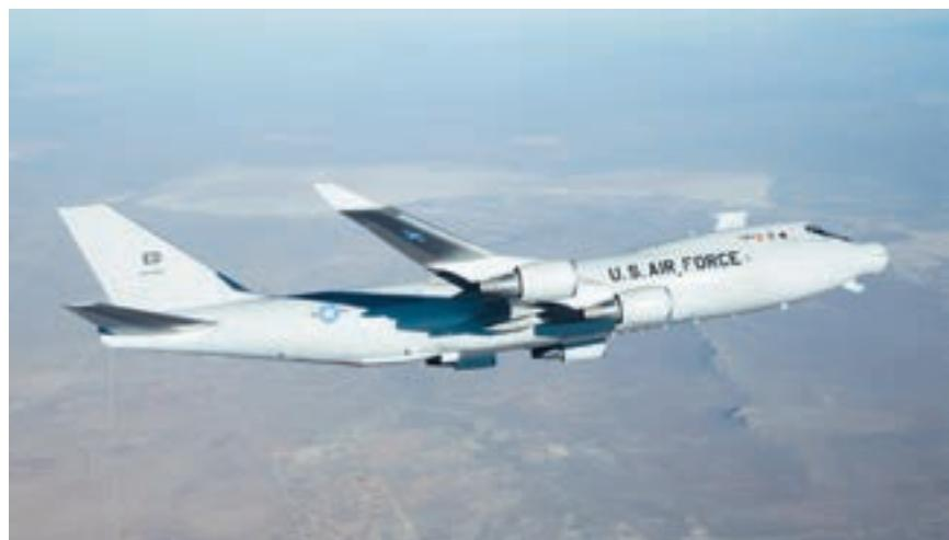
obavljano u laboratorijskim uvjetima, odnosno tijekom prošle godine obavljeno je letno ispitivanje pomognoga laserskog ciljničkog sustava poput TILL-a (Tracking Illuminator Laser), namijenjenog za zahvat i praćenje lansiranih balističkih projektila i snage jednog krovata, te uspješnosti integriranja nosne turele u koju je smješten dio cjelokupnog laserskog sustava.
