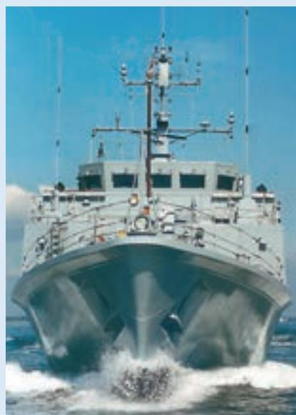
propulzora Schottel. Odvojena elektropropulzija osigurava brzinu bez stvaranja šumova do 7 čvorova. Za otkrivanje i klasifikaciju mina rabi se sonar promjenjive dubine Type 2093, a na palubi su smještena dva podvodna daljinski upravljana plovila tipa PAP 104 Mk5.
