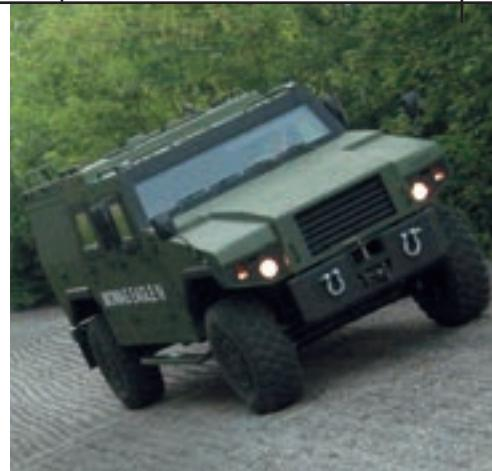
2,16 m. Može primiti do pet osoba. Pokreće ga turbodizelski motor Cummins snage 245 KS te automatskog mjenjača s pet brzina Allison. Po dobrom putu postiže najveću brzinu od 110 km/h.
