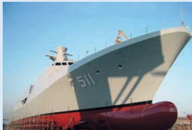
Osnovne značajke novih korveta opisane su istisnina 2000 t i duljina 99 m. Propulzijski sustav sastoji se od dva 16-cilindarska MTU dizelska motora, od kojih je svaki snage 4320 kW i plinske turbine LM2500 tvrtke General Electric snage 23 000 kW, CODAG (kombinirani rad dizelska motora i plinske turbine) konfiguracije, osovinskih vodova i propelera s promjenjivim usponom krila. Uporabom obaju izvora energije, korvete bi trebale postizati maksimalnu brzinu veću od 29 čv.
