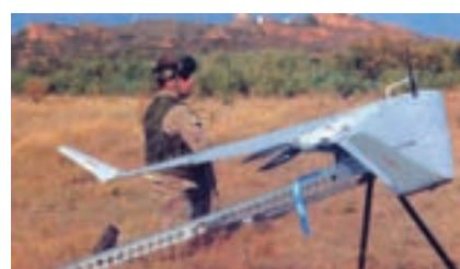
zemlju vraća autonomno spuštajući se na meku podlogu. Uobičajeni operativni vrhunac leta iznosi 900 m, dok maksimalni iznosi 3200 m. Za pogon se rabi elektromotor koji se napaja energijom iz litijске baterije, koja Strixu omogućava boravak u zraku do 1,5 sati. Cijeli sustav (uključujući rampu za lansiranje) je lako sklopiv i prenosiv, i teži oko 25 kg.
