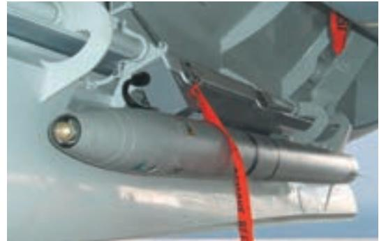
velika otpornost na obrambeni sustav IC mamaca. Raspon učinkovitog dometa ASRAAM-a kreće se od 300 m do 15 km, maksimalna brzina koju može postići je 3+ M. Ukupna težina projektila iznosi 100 kg, od čega bojna glava teži 10 kg.
