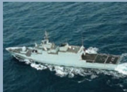
Glavne značajke nove korvete su duljina od 88 m, širina 12 m uz maksimalnu istisninu od 1650 t. Predviđa se postizanje maksimalne brzine od 25 čv dok će autonomija broda uz brzinu od 14 čv iznositi više od 3000 Nm zahvaljujući pogonskom sustavu od dva dizelska motora snage 7000 kW. Posada će imati oko 70 mornara, dočasnika i časnika.
