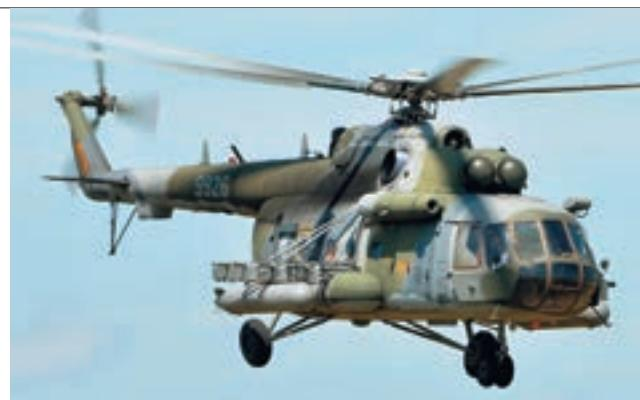
odnosno novu inačicu s oznakom Š, čime se označava jurišna namjena letjelice (Šturmovik - jurišnik). Na vanjskim nosačima Mi-171Š može uz "korisni" teret nositi i naoružanje, i to: navođene protuoklopne projektilne Ataka i Šturm, nevođene projektilne S-8 s nosačima B8V20-A, kontejnere s topom UPK-23-250, te strojnica PKT (koje se mogu montirati i ispod nosne sekcija helikoptera) i AKM (RPK, PK).
