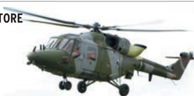
prijašnje turbovratilne motore Rolls-Royce Gem Mk 42. Uz to, što je uobičajeno za nove generacije motora, popratna pojava su niži operativni troškovi, te znatno bolje tzv. hot
