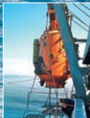
matičnog broda do dubine na kojoj se, preko otvora istih dimenzija koji se nalaze na zvonu i podmornici, spaja s podmornicom neovisno o tome vlada li u podmornici normalni ili povišeni tlak. Na isti se način s potonulom podmornicom spaja spasilačka podmornica. Brod "Belos" može se spojiti s potonulom podmornicom pod kutom od 45° i odjednom prevesti najviše 35 podmorničara. Kut pod kojim bi se podmornica nakon potonuća našla na dnu jest kritični element za mogućnost spašavanja na taj način.
