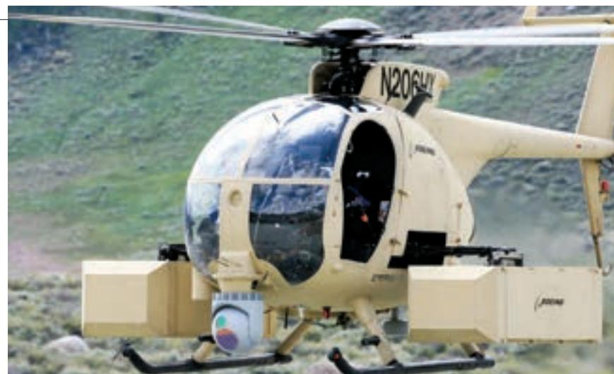
u zraku. Probni let proveden je bez poteškoća. Boeing kani inačicu AH-6i primarno ponuditi na međunarodnom tržištu, dok bi se za američke oružane snage po svemu sudeći rabila inačica AH-6S. Bespilotni helikopteri AH-6i i AH-6S namijenjeni su
