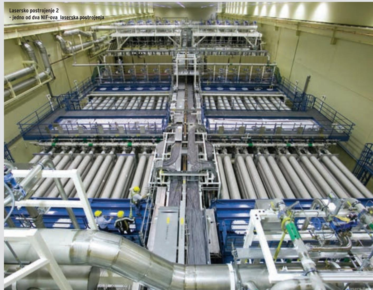
se aktiviraju električnom energijom iz napunjenih kondenzatora. Intenzivna bijela svjetlost energizira atome neodija te ovu energiju prenose u laserske zrake. Da bi se osigurala visoka kvaliteta laserske zrake, specijalna deformabilna zrcala i ostala oprema brine se za visoku kvalitetu, uniformnost te njezinu glatkoću.
