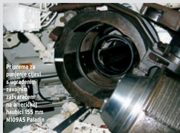
Priprema za punjenje cijevi s ugrađenim zavoјnim zatvaračem na američkoj haubici 155 mm M109A5 Paladin
