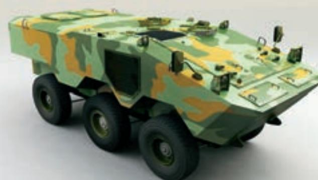
do 2011. Masa novog vozila je 18 tona, pogonska konfiguracija je 6x6, može primiti 11 ljudi a modularnost će se ogledati u mogućnosti izrade raznih inačica na temelju istog podvozja.
