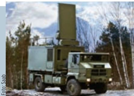
opremu. ARTHUR je radarski sustav za lokaciju protivničkog topništva, otkriva i prati protivničke topničke projektile, proračunava polazni položaj i mjesto udara, a simultano proračunava i protumjere. Domet mu je do 60 km, a u minuti može obraditi 100 ciljeva. Radi na frekvenciji od 5,6 do 5,9 GHz.
