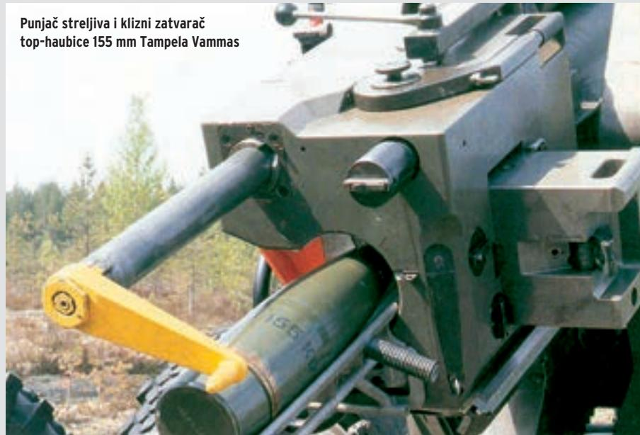
zatvarači. Prvi su češće u primjeni kod oružja manjih kalibara, a otvaranje se obavlja odozgo prema dolje, ali to nije pravilo. Otvaranje horizontalno-kliznih zatvarača najčešće je u desnu stranu gledajući u smjeru paljbe. Klizni zatvarači su u pravilu teži od zavojnih i složenije su konstrukcije jer u sebi imaju integrirane odgovarajuće polužne mehanizme za pokretanje i kočenje zatvarača, a ponekad i poluge za izbacivanje čahure.
