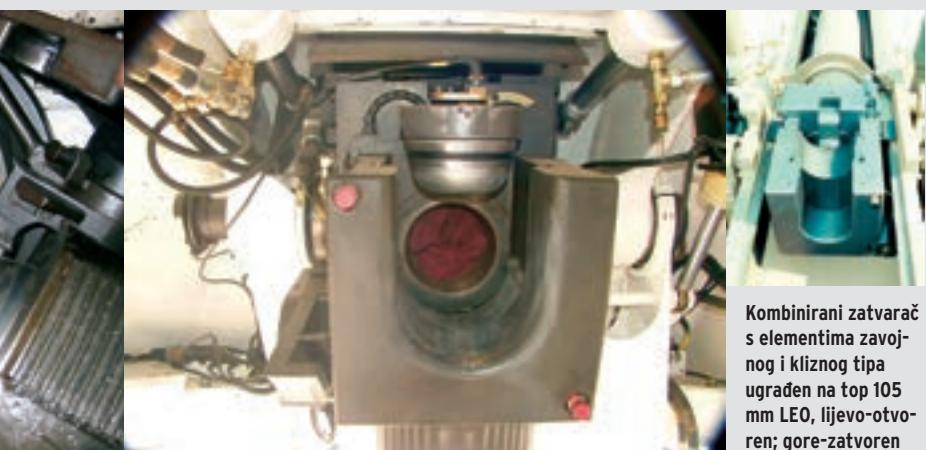
Kombinirani zatvarač s elementima zavoјnog i kliznog tipa ugrađen na top 105 mm LEO, lijevo-otvoren; gore-zatvoren
