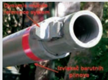
Detalj cijevi s ugrađenim izvlačačem barutnih plinova i senzorom za pomicanje cijevi (DRMS)
