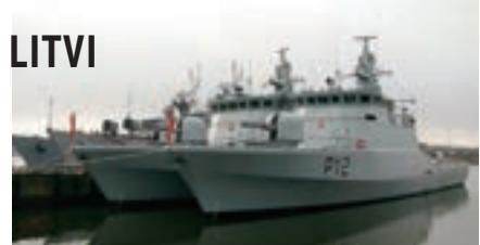
su građeni uporabom sendvič konstrukcije: sloj staklenih vlakana s obje strane jezgre načinjene od PVC sačaste pjene. Ovim izborom materijala i načinom gradnje izgrađeni su svi brodovi od kobilice do vrha jarbola pri čemu su se troškovi održavanja znatno smanjili.
