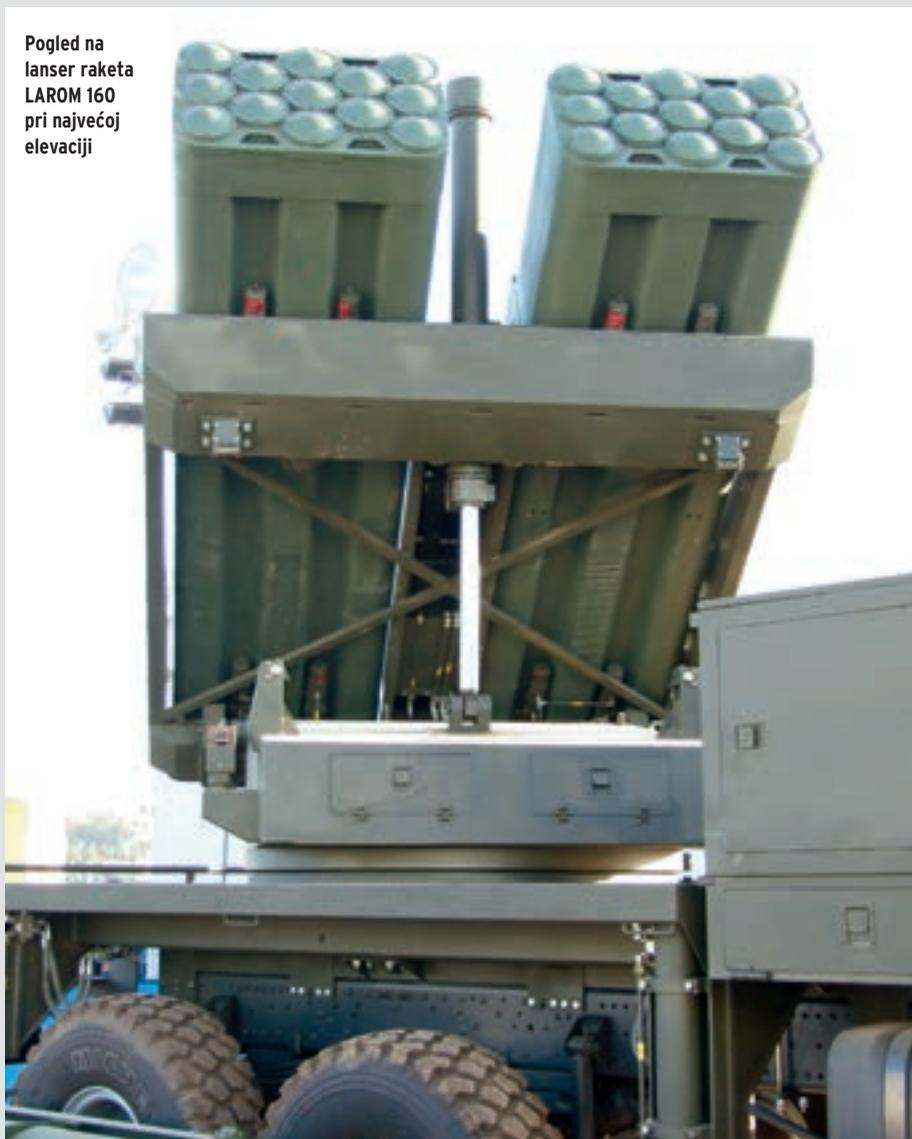
lizatora sa stražnje strane vozila, koji se postavljaju u pripremu za paljbu. Kada je oružje u transportnom položaju, lansirni uređaj se prekriva hidraulički upravljanim uređajem za navlačenje cerade.
