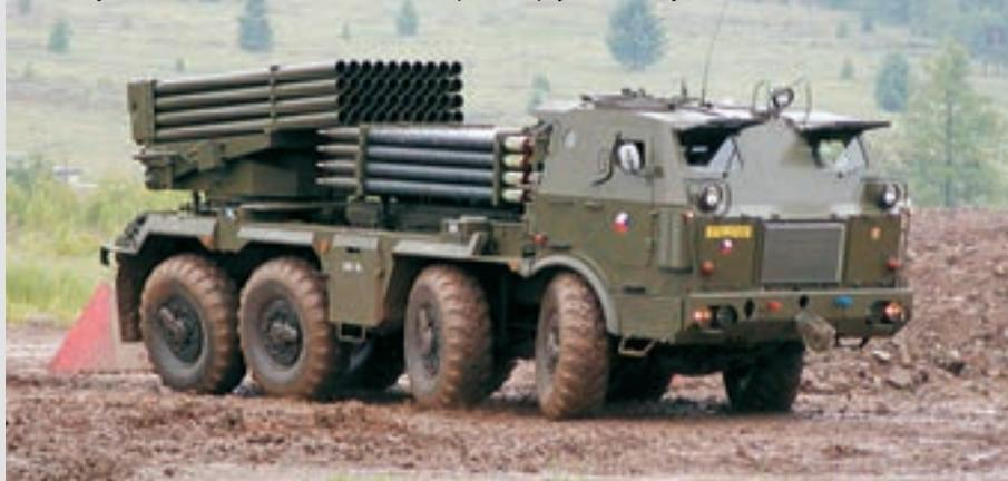
raketni sustav s najvećim dometom u kalibru, 122 mm. Lansirni se uređaj u načelu sastoji od dva izmjenjiva modula po 20 lansirnih cijevi dužine 3,7 metara, smještenih na odgovarajuće podvozje terenskog kamiona Mercedes-Benz 6x6.
