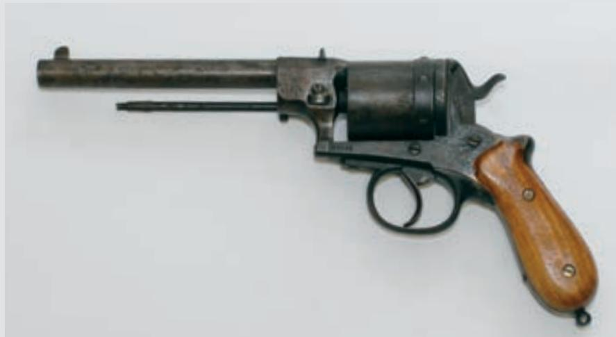
Revolver ima bubanj za šest metaka s obaračem i udarnom iglom. Cijev je okrugla, s unutarnje strane ižlijebljena. Sa strane cijevi je šipka za izbijanje čahura. Okidač je s branikom. Na rami revolvera piše broj 13 806, koji se nala-
