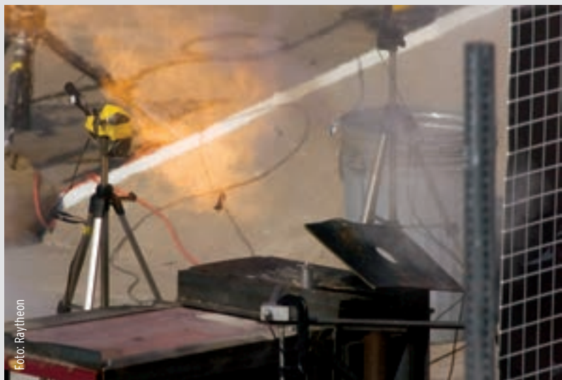
Testiranje djelovanja laserske zrake na minobacački projektil
