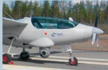
maksimalno do 250 kg, od čega 80 kg ispod svakog krila. Prema navodima Sagem, besposadni sustav Patroller može nositi i navođene projektile zrak - zemlja AGM-114 Hellfire. Od elektrooptičke opreme može nositi EuroFlir 410, TV i infracrvene kamere te mornarički radar.
