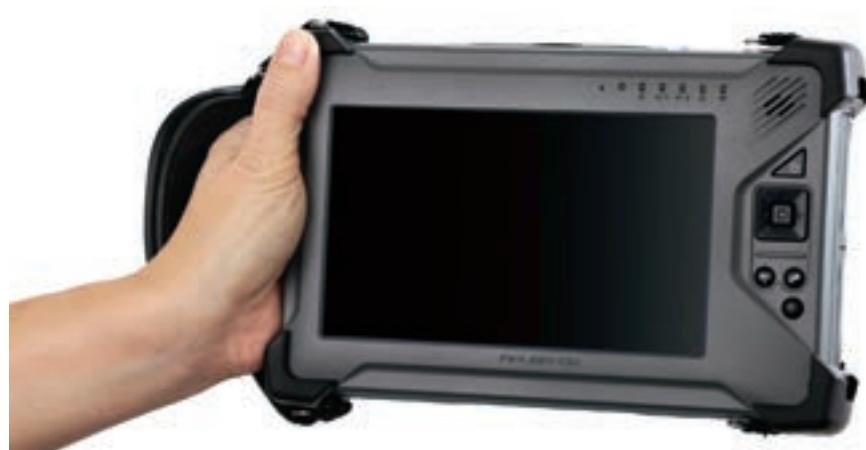
od 120GB. Dvije baterije od 2500 mAh, s mogućnošću zamjene tijekom rada osiguravaju autonomiju od pet sati. Od tehnologija ima Wi-Fi, Bluetooth, GPS,
