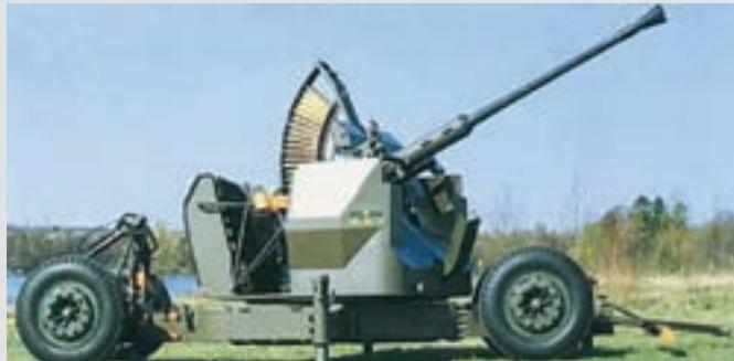
opremljeno topom 40 mm dužine cijevi 70 kalibara. Opremljen je najsuvremenijim (za ono vrijeme) lasersko-računalnim uredajem za upravljanje paljbom. Prema nekim podacima, u prvim godinama nabavljeno je 130 komada oružja.
