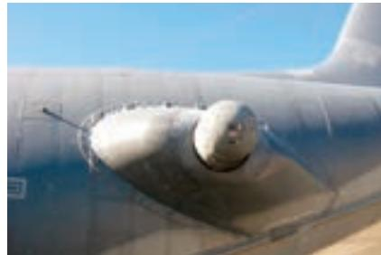
potom usmjerava svoje ometanje prema mjestu iz kojeg dolazi protivnički projektil. Sustav je potpuno samostalan, što znači da sam prema potrebi reagira na ispaljene projektile, i aktivira laserski blok, bez dodatnog angažiranja posade.
