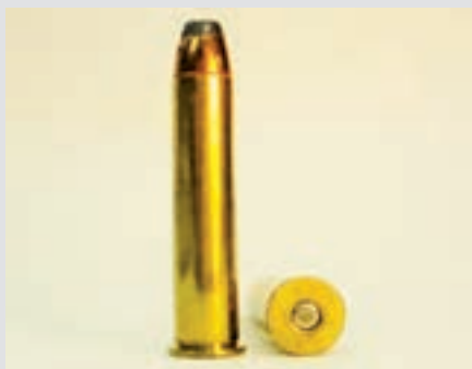
Metak .45-70 Gov. (11,63 x 54 mm). Primarno je razvijen za vojnu pušku Springfield M 1873., ali je rabljen i u velikom broju revolvera. U većoj količini rabile su ga američke postrojbe u Španjolsko-američkom ratu, kada je zadovoljavao balističke zahtjeve puščanog streljiva (početna brzina 487 m/s; izlazna energija zrna 235 kpm), međutim za revolver je bio presnažan
