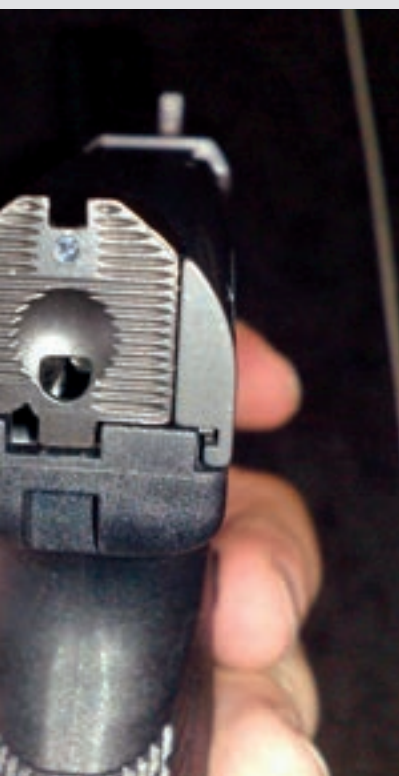
Navlaka je izrađena od karbonskog čelika visoke kakvoće kao i cijev, koji su uostalom kao i svi ostali metalni dijelovi zaštićeni tzv. Plasoxom, posebnim postupkom otvrdnjavanja vanjske površine pomoću ioniziranih molekula plina dušika
