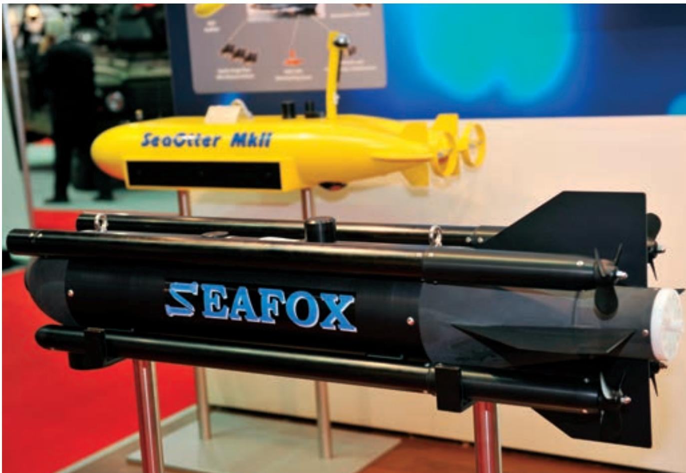
Ronilice SeaFox i SeaOtter Mk II Atlas Elektronika namijenjene su protuminskom djelovanju, nadzoru, obuci, izviđanju i sličnim zadaćama. SeaOtter Mk II je ronilica dugačka 3,65 m i mase oko 1000 kg. Manja ronilica SeaFox dugačka je 1,31 m i ima masu 43 kg te može zaroniti do 300 metara dubine
