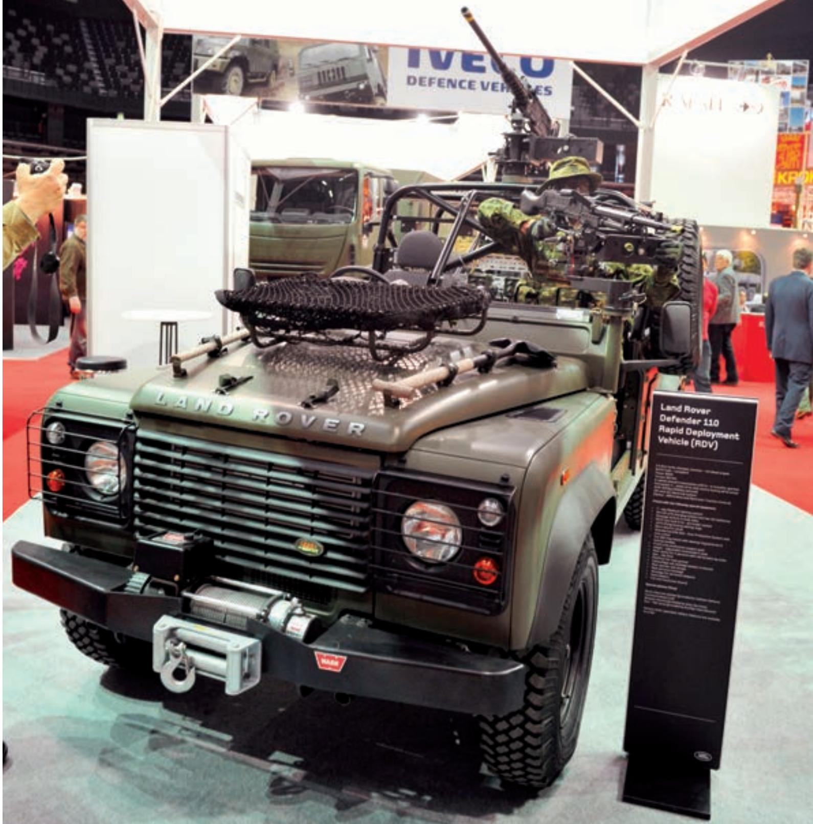
Terensko vozilo Land Rover Defender 110 RDV (Rapid Deployment Vehicle) odnosno intervencijsko vozilo za brzi razmještaj. Fleksibilni tovarni prostor omogućava smještaj streljiva, opreme i potrepština. Na prednjem dijelu vozila, na poziciji suvozača postavljeno je postolje za strojnicu kalibra 7,62 mm a u sredini vozila je postavljeno okretno postolje koje može prihvati tešku strojnicu kalibra 12,7 mm ili automatski bacač granata kalibra 40 mm
