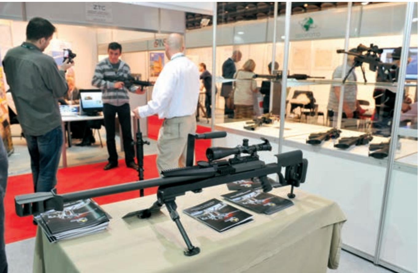
Teška snajperska puška AR-50A1, kalibra .50BMG je zbog napredne konstrukcije vrlo precizna, a posebni tehnološki postupci i materijali rezultirali su snažnim kućištem; na kraju cijevi načinjene od čelika oplemenjenog krom molibdenom postavljena je učinkovita plinska kočnica koja znatno reducira trzaj oružja
