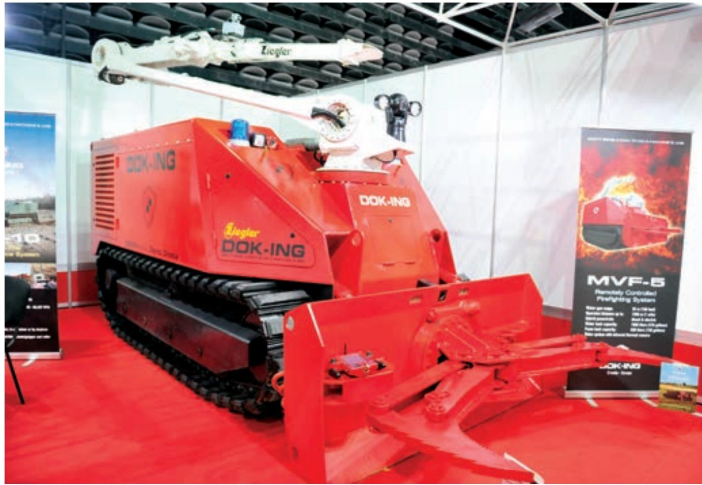
DOK-ING je uz poznati stroj za razminiranje MV-4 prikazao i stroj MVF-5. To je novi proizvod namijenjen borbi protiv požara. Upravlja se daljinski te je pogodan za gašenje požara svugdje gdje je to opasno za ljude. Snažno podvozje na gusjenicama omogućava mu dobro prometovanje i po najtežim podlogama, a fleksibilni radni alat omogućava gašenje požara iz potrebnog smjera.
