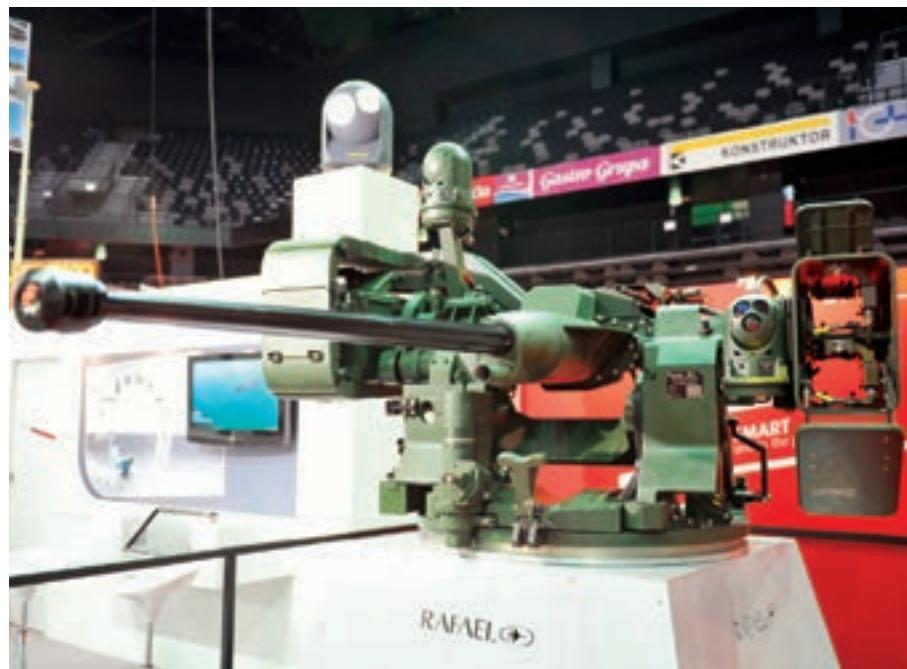
Paljbeni stanica Samson tvrtke Rafael slijedi sličnu filozofiju kao i paljbeni stanica UT30 tvrtke Elbit. Jednostavno se instalira na vozilo, konstrukcijski ne ulazi u unutrašnjost vozila i ne troši dragocjeni unutrašnji prostor, napredni sustav za upravljanje paljbeom omogućava motrenje kruga oko vozila, ciljanje i automatsko praćenje cilja
