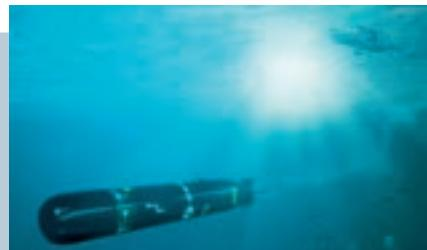
NH-90. Temeljna obilježja lakih torpeda Sting Ray očituju se u sofisticiranom akustičnom sustavu navođenja, iznimno preciznom navigacijskom sustavu te mogućnosti detekcije, klasifikacije i napada na ciljeve. Osim toga torpeda odlikuje visoka brzina i manevrabilnost, duboko ronjenje, mala buka, napredna računalna inteligencija, djelotvornosti bojne glave, smanjeno održavanje i dobra operativna dostupnost.
