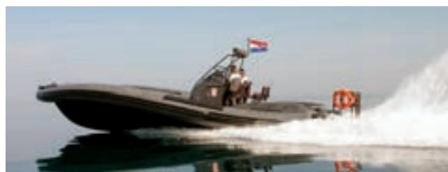
rova. Posebnost broda je njegovo ponašanje na valovima, nemirnom moru, koje osigurava njegovu upotrebljivost do većih stanja mora. Brod je opremljen profesionalnim radom Raymarine, GPS uređajem i FLIR kamerom. Upotreba specijalnih materijala u konstrukciji i izgradnji trupa osigurava zaštitu ljudi od streljiva lakog kalibra. Na pramčanom dijelu broda može se ugraditi lako naoružanje (do 12,7 mm) upravljivo s konzole smještene u sredini broda.
