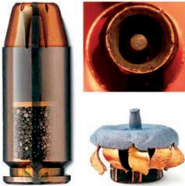
Pištoljski metak s "hydra-shock" zrnom: bočni izgled s djelomičnim presjekom (lijevo), šuplji vrh zrna s trnom (gore) i izgled zrna nakon pogotka u cilj (dolje)
