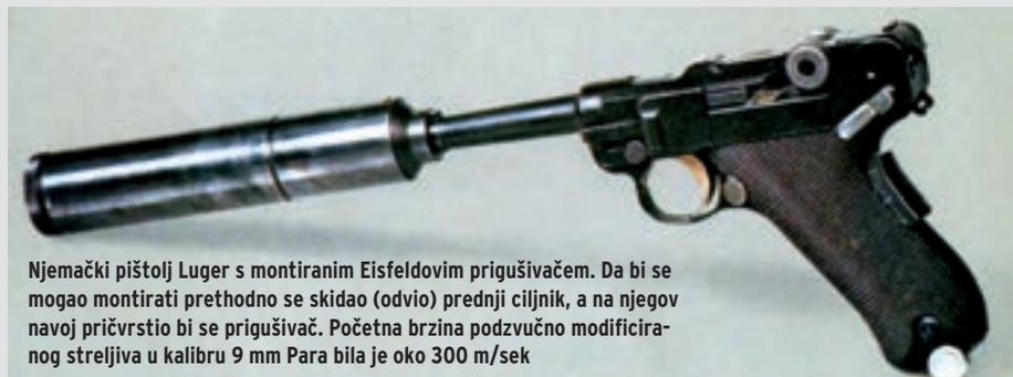
Njemački pištolj Luger s montiranim Eisfeldovim prigušivačem. Da bi se mogao montirati prethodno se skidao (odvio) prednji ciljnik, a na njegov navoj pričvrstio bi se prigušivač. Početna brzina podzvučno modificiranog streljiva u kalibru 9 mm Para bila je oko 300 m/sek
