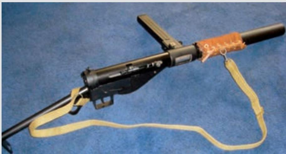
Prigušena britanska kratka strojica Sten Mk 2S. Od standardnog modela je malo teži (4,14 kg u odnosu na 3,2 kg standardnog modela) i duži (857 mm u odnosu na 762 mm). Rabio je modificirano podzvučno streljivo 9 mm Para početne brzine 305 m/sek, a u pravilu je gadao pojedinačnom paljbom, iznimno kratkim rafalima, zbog mogućeg pregorijevanja i trošenja pregrada prigušivača. Redukcija buke pucnja bila je vrlo solidnih -36 db
