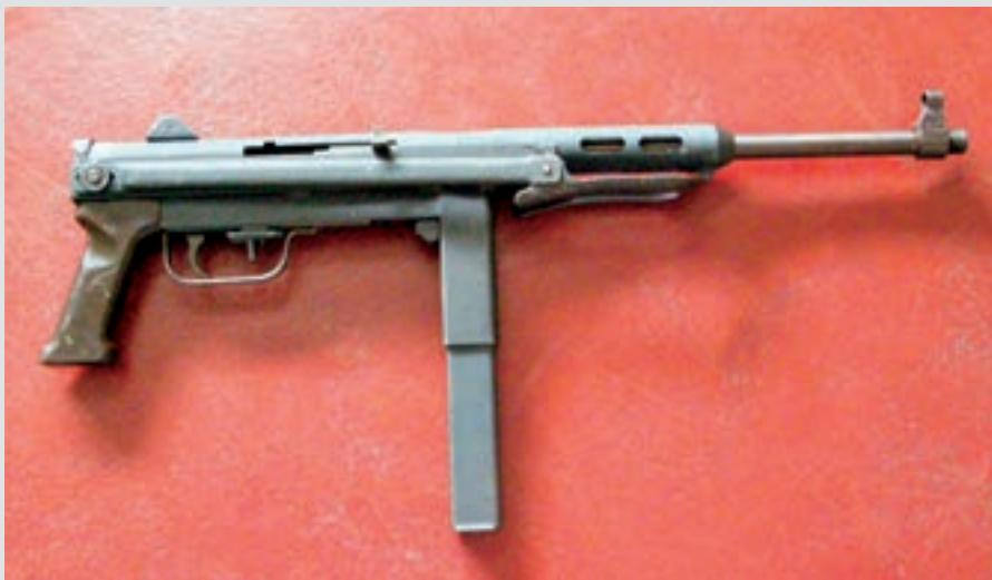
su u potpunosti kopirani s PPŠ-a, dok je spremnik za razliku od originalnog dvoredni i ravan, po uzoru na spremnik kratke strojnica Uzi. Jednostavnii ciljnici omogućavaju zadovoljavajuću preciznost
