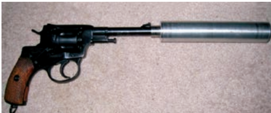
"Nagant" M-1895 s originalnim prigušivačem. U neprigušenoj inačici revolver je imao masu 800 g; dužinu 235 mm i dužinu cijevi 114 mm. Buban je imao kapacitet 7 metaka kalibra 7,62 mm Nagant, a učinkoviti domet do 22 m. Prigušenim inačicama učinkoviti domet je bio vjerojatno nešto manji
