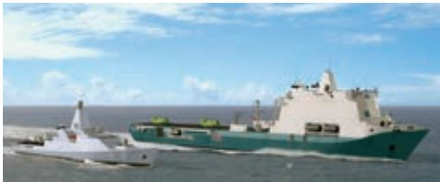
dva helikoptera tipa NH90 ili Chinook dok je hangar dovoljno prostran za smještaj šest helikoptera. Najveća je brzina 18 čv dok je doplov 9800 Nm pri brzini od 12 čvorova. Pogonski je sustav kombinirani dizelsko-električni ukupne instalirane snage 18 000 kW. Temeljno brodsko naoružanje sastoji se od dvaju sustava namijenjenih bliskoj borbi Goalkeeper te četiri automatska srednjokalibarska sustava.
