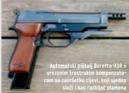
Automatski pištolj Beretta 93R s urezanim trostrukim kompenzatom na završetku cijevi, koji ujedno služi i kao razbijajući plamen
