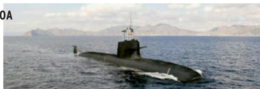
terija Tudor kao i AIP pogon s gorivnim ćelijama snage 300 kW, koji se temelji na iskorištavanju modificiranog etanola i tekućeg kisika. Navantia razvija AIP pogonski sustav u suradnji s tvrtkama UTC Power i Hyergreen. Predviđa se da bi podmornice s takvim propulzijskim sustavom trebale postići površinsku brzinu od 12 čv, dok bi podvodna iznosila 19 čv. Temeljno naoružanje podmornica S-80A činiće električno
