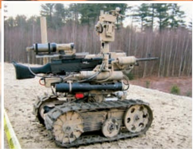
dvije palice od kojih je jedna za robota, druga za oružje koje je instalirano na robota. SWORDS-ovo djelovanje se nadzire preko zaslona za prikaz podataka odnosno slike s kamera.
