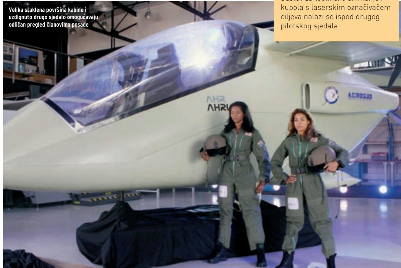
AHRLAC je visokokrilac dvosjed s težišmom točkom pomaknutom naprijed te dva repna stabilizatora koji su ugrađeni u krila, a ne u trup aviona. Središnja je gondola pojačana da bi podnijela teret posade koja je smještena u prednjem dijelu letjelice u helikopterskom stilu, a motor se nalazi otraga.
