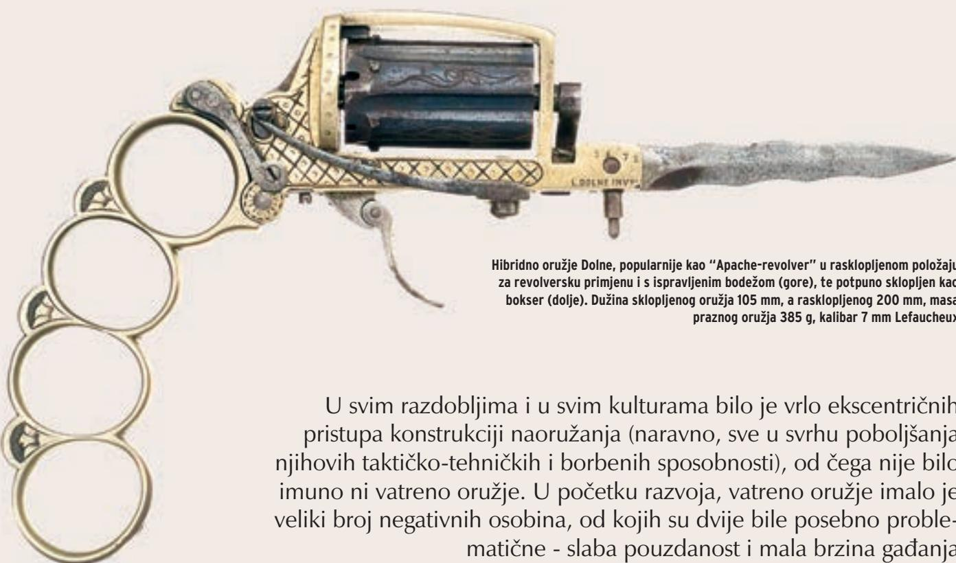
Hibridno oružje Dolne, popularnije kao "Apache-revolver" u rasklopljenom položaju za revolversku primjenu i s ispravljenim bodežom (gore), te potpuno sklopljen kao bokser (dolje). Dužina sklopljenog oružja 105 mm, a rasklopljenog 200 mm, masa praznog oružja 385 g, kalibr 7 mm Lefaucheux
