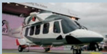
Uz to, unutrašnjost je moguće vrlo lako i brzo prilagoditi na nosila za ozlijedene osobe te za prateću medicinsku opremu. Pogonsku skupinu čine dva turbovratilna motora GE CT7-2E1 svaki jakosti 2,684kW, koji omogućavaju krstareću brzinu u rasponu od 268-278km/h.
