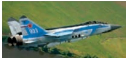
MiG-31BM je sposoban raditi zahvat ciljeva udaljenih do 400 km, odnosno sposoban je istodobno pratiti do 24 različita cilja u zraku i na zemlji. Temeljni arsenal MiG-a 31B čine projektili zrak - zrak i to R-73 (AA-11 Archer), R-77 (AA-12 Adder), R-33S (poboljšani AA-9 Amos) i K-37M (AA-X-13 Arrow), odnosno vrlo sposoban proturadarski (zrak - zemlja) projektil AS-17 Krypton.
