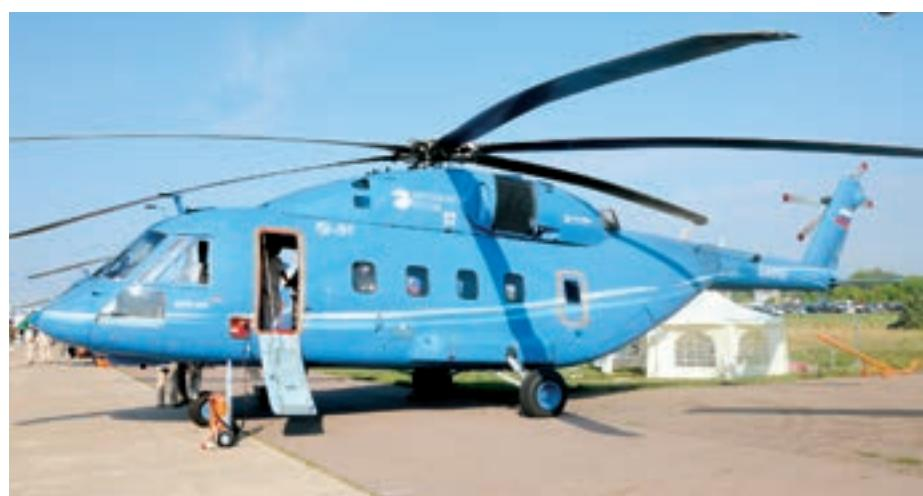
Prototip civilno-transportnog helikoptera Mil Mi-38 OP-2 s kanadskim motorima
