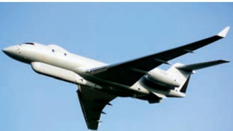
Sentinel R1 opremljen je radarem DMR (Dual Mode Radar) čija je antena ispod prednjeg dijela trupa
