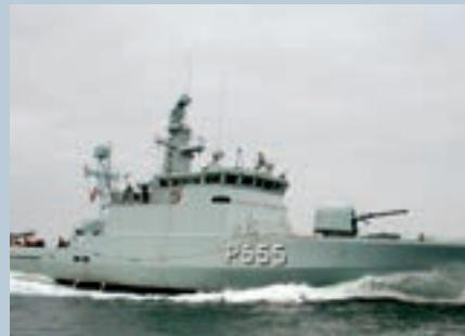
se kontejner smješta na pramac dok se preostala tri smještaju na krmenu palubu iza nadgrađa i dimnjaka. Nadalje, brodovi su građeni uporabom sendvič konstrukcije: sloj staklenih vlakana s obje strane jezgre načinjene od PVC sačaste pjene.
