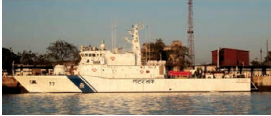
od 14 čv, doplov broda iznosi 1500 Nm, dok posadu čine zapovjednik broda, pet časnika i 34 mornara. Posebne značajke broda uključuju napredni upravljački sustav, sustav nadzora pogonske jedinice te postolje topa uključujući sustav kontrole paljbe vlastitog dizajna. Plovilo nosi jedan gumenjak s tvrdim dnom te dva robot-
