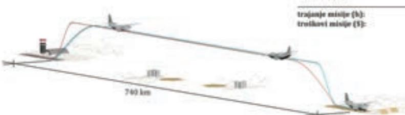
**Shema 1.** Zbog dvostruko manje brzine CH-47D će na ruti provesti dvostruko više vremena nego C-27J. Kada se to pomnoži s pet puta većim operativnim troškovima, proizlazi da su troškovi misije za CH-47D otprilike deset puta veći nego za C-27J
