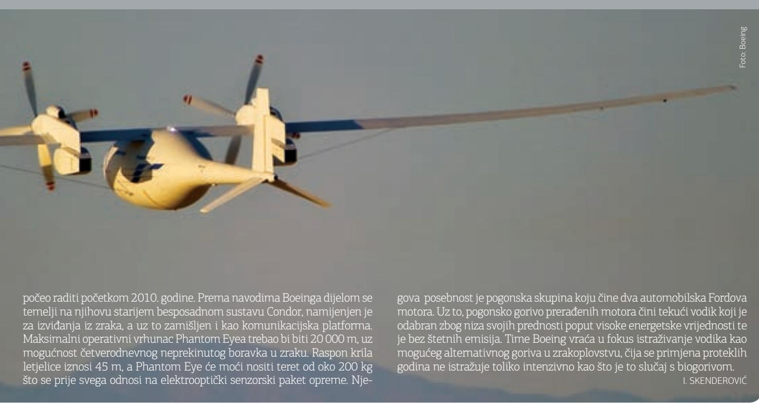
počeo raditi početkom 2010. godine. Prema navodima Boeinga dijelom se temelji na njihovu starijem besposadnom sustavu Condor, namijenjen je za izviđanje iz zraka, a uz to zamišljen i kao komunikacijska platforma. Maksimalni operativni vrhunac Phantom Eyea trebao bi biti 20 000 m, uz mogućnost četverodnevног neprekinutog boravka u zraku. Raspon krila letjelice iznosi 45 m, a Phantom Eye će moći nositi teret od oko 200 kg što se prije svega odnosi na elektrooptički senzorski paket opreme. Nje-
