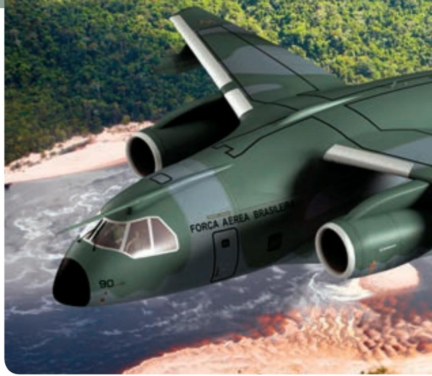
nja u naše rješenje nego u moderne kompozitne propelere. U suvremenim turboventilatorskim (turbofan) mlaznim motorima vrlo mali dio zračne struje ulazi u jezgru motora, a sam je ventilator vrlo robustan.
