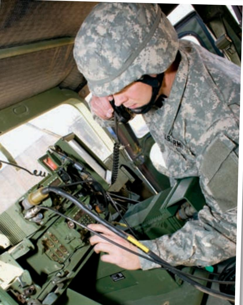
Podrška je i internetski protokol (IP) optimiziran za SINCGARS-ov Internet Networking Controller (INC) tehnologiju, a može se koristiti preko bilo koje standardne IP taktičke, lokalne ili wide area mreže. Moduli omogućavaju spajanje sustava S-TBMS sa senzorima radi distribucije informacija putem radijske mreže. Uključuju meteo stanicu, biometriju (otisak prsta ili slika), a omogućeno je i spajanje na uredske sustave te sustave elektroničke pošte (IBM Lotus Notes, MicrosoftOutlook i sl.).
