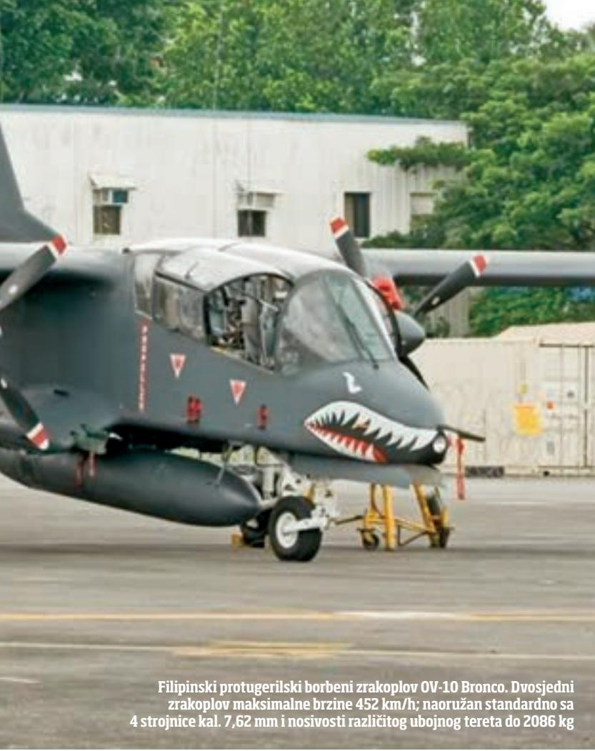
**Filipinski protuterilski borbeni zrakoplov OV-10 Bronco. Dvosjedni zrakoplov maksimalne brzine 452 km/h; naoružan standardno sa 4 strojnica kal. 7,62 mm i nosivosti različitog ubojnog tereta do 2086 kg**
