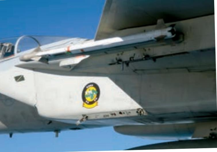
**Projektil AIM-9X na potkrilnom nosaču borenog aviona F-15C**
