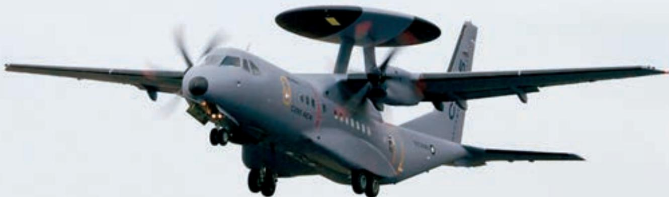
C295 AEW&C inačica razvijena je u suradnji s izraelskom tvrtkom IAI/Elta koje je bila zadužena za ugradnju i integraciju specifičnog radarskog sustava
