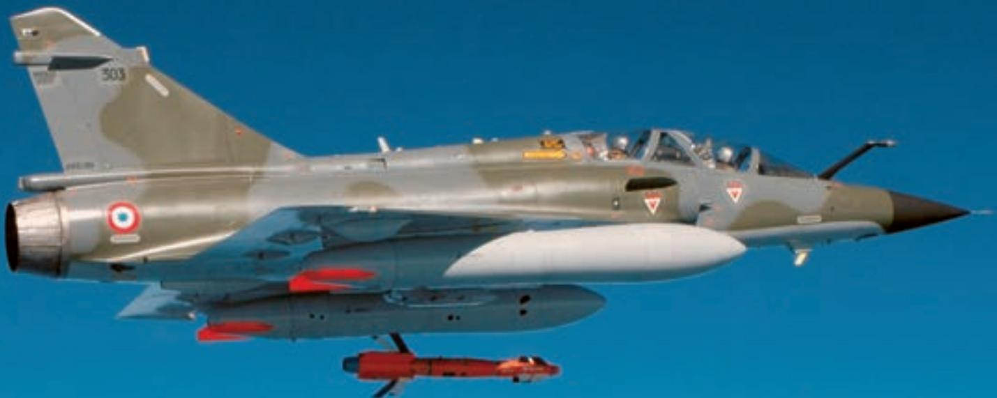
Mirage 2000D ispušta vodenu bombu produženog dometa AASM
