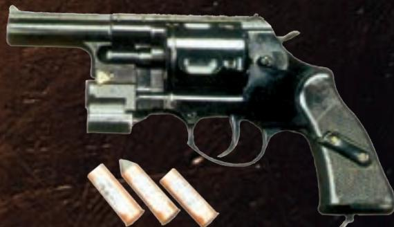
**OC-20 Gnom gлатkocijevni revolver dvostrukog djelovanja. Kalibr 12,5x40 mm, kapacitet bubnja 5 metaka, dužina 250 mm, masa 1100 g prazan. Daljina gadanja 50 m**
