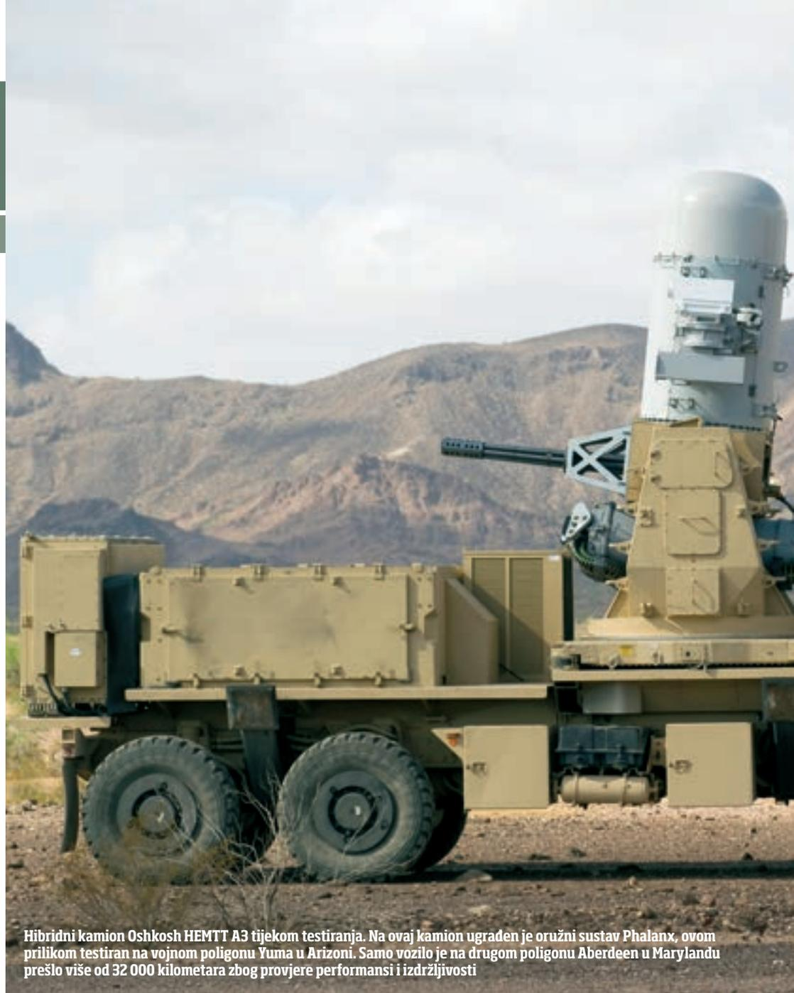
**Hibridni kamion Oshkosh HEMTT A3 tijekom testiranja. Na ovaj kamion ugrađen je oružni sustav Phalanx, ovom prilikom testiran na vojnom poligonu Yuma u Arizoni. Samo vozilo je na drugom poligonu Aberdeen u Marylandu prešlo više od 32 000 kilometara zbog provjere performansi i izdržljivosti**
