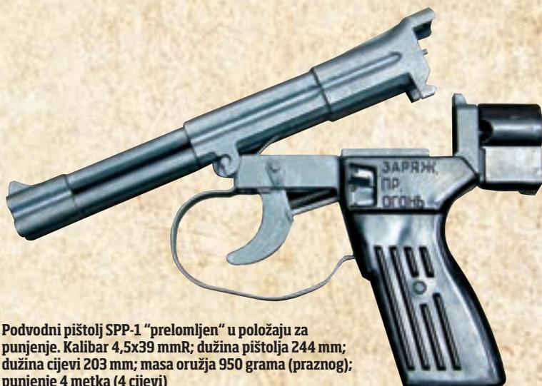
Podvodni pištolj SPP-1 "prelomljen" u položaju za punjenje. Kalibar 4,5x39 mmR; dužina pištolja 244 mm; dužina cijevi 203 mm; masa oružja 950 grama (praznog); punjenje 4 metka (4 cijevi)
